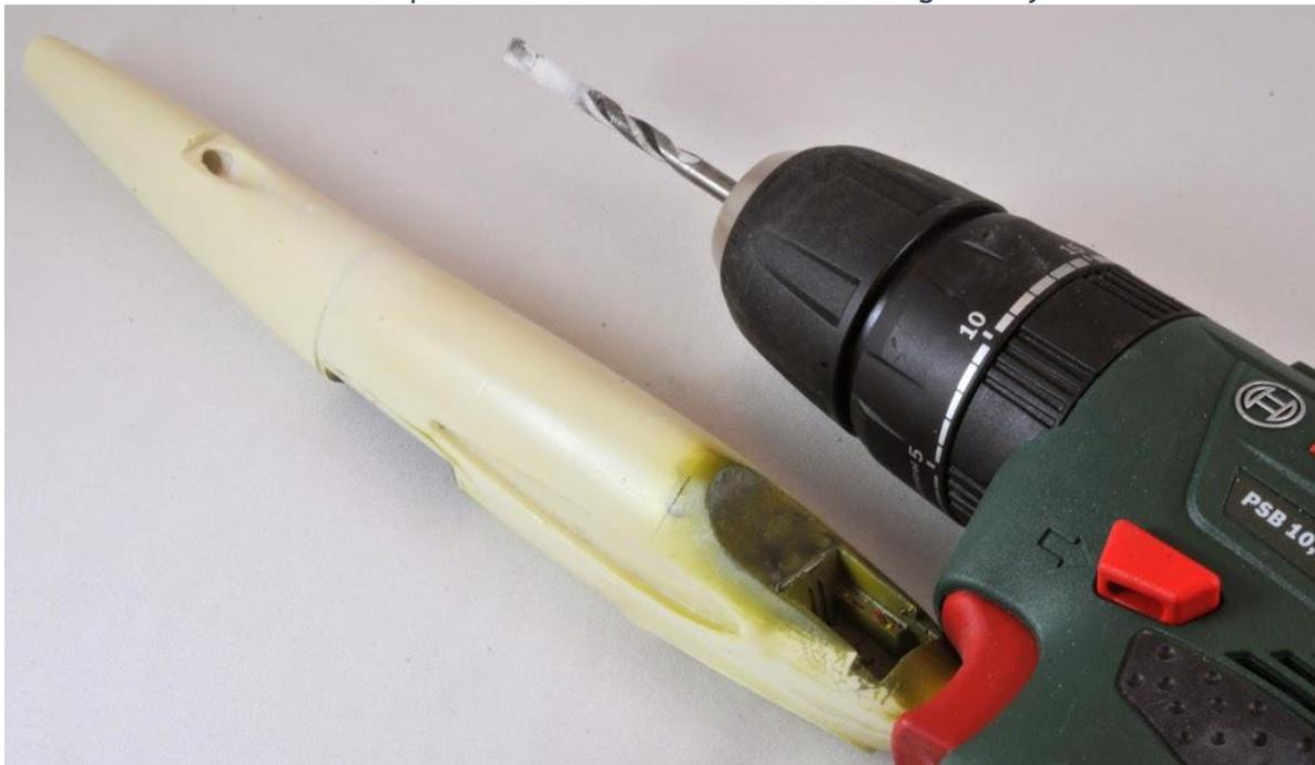
L'entrée d'air dorsale est parfaite si la résine n'était pas si fragile, j'ai réussi à en péter un morceau...à rattraper au Sintofer.
