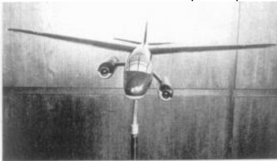
EF 68. Suche nach günstigstem Abstand der Strahltriebwerke vom Rumpf.
