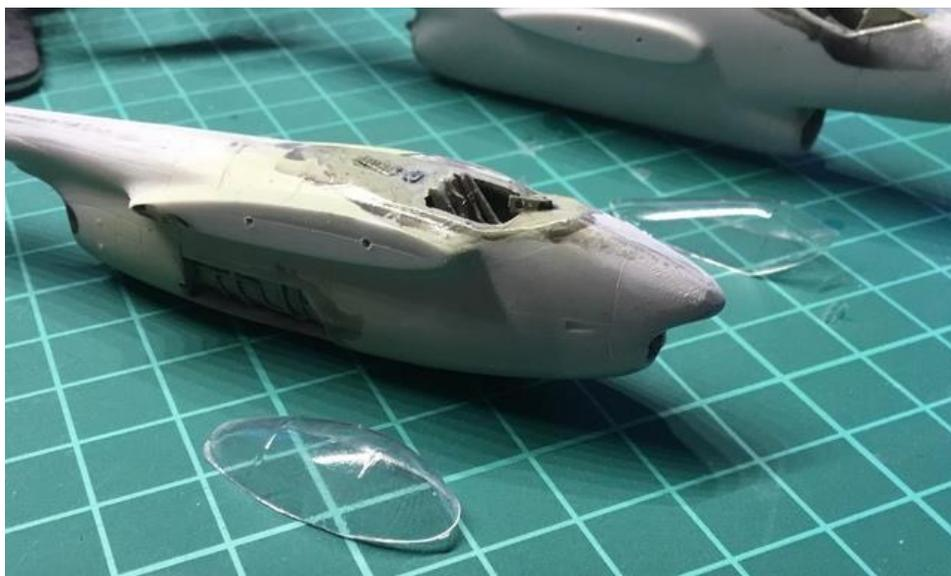
La verrière est trop haute sur l'avant et casse la ligne de l'avion, un gros ponçage s'impose.
